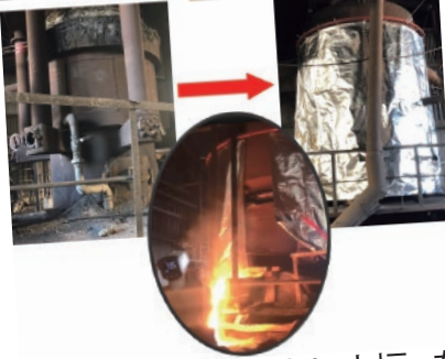
キューポラ<鉄を溶かす炉>を スポリ包み込みました
