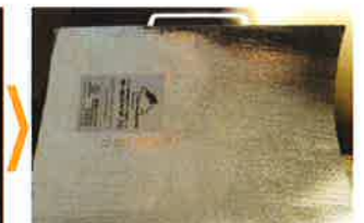
サーモバリアにハロゲンライトを当てる ハロゲンライトの光を完全に反射しています。
