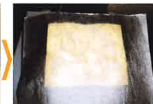
アルミ蒸着品にハロゲンライトを当てる ハロゲンライトの光が透き通って見えます。
